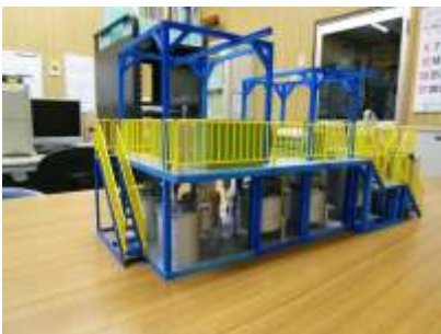
RP装置による造形モデル (着色済み)
